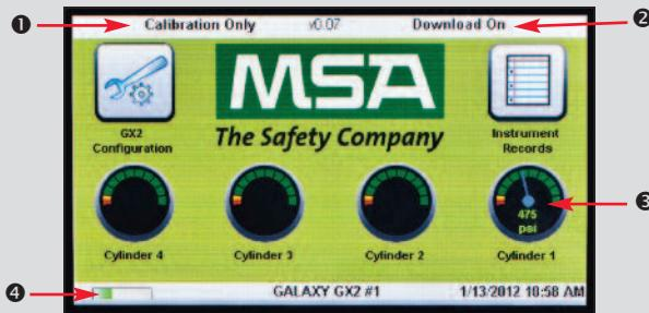
Administratörskärmens tillhandahåller konfigurationsalternativ för testbänken, instrumentet och testgascylindrarna:
