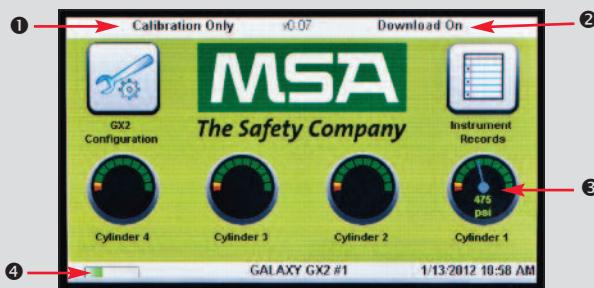
На екрані «Адміністратор» передбачені опції для налаштування випробного стендса, пристрою і балонів з контролльним газом.
