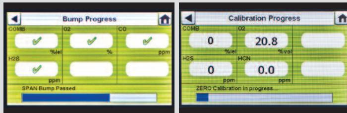
For bump-en,fremdriftsskjerm vises det et timeglass i hver sensorboks til bumpen til denne sensoren er fullført. Et grønt avkryssningsmerke (✓) eller rødt X (✗) vises for hver sensor når bump-testen er ferdig.
