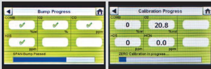
Para a tela de Progresso Bump Teste, um símbolo de ampulheta aparecerá em cada caixa de sensor até que o teste de resposta do sensor seja completado. Um sinal de seleção verde (✓) ou um X vermelho (✗) aparece para cada sensor quando o teste de resposta, ou bump teste, for completado.
