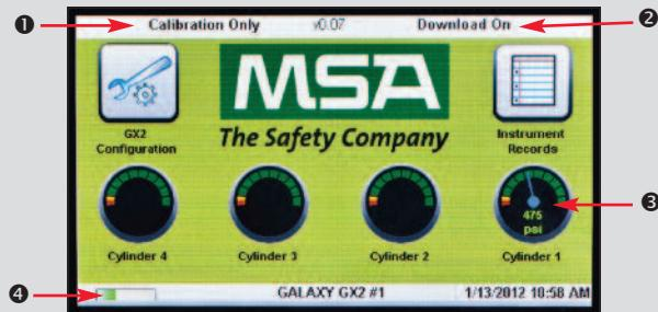
La schermata Amministratore fornisce opzioni di configurazione per il banco prova, lo strumento e le bombole di gas di prova.
