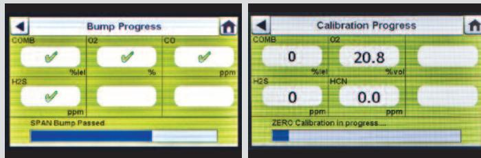
In het voortgangsscherm van bump verschijnt een zandloperssymbool in elke sensorbox totdat de bump-test van de sensor voltooid is. Een groen vinkje [✓] of rode X [✗] verschijnt bij elke sensor wanneer de bump-test voltooid is.
