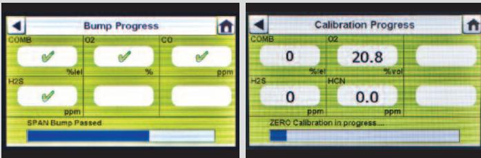
Στην οθόνη Πρόδος ελέγχου απόκρισης αερίου, εμφανίζεται το σύμβολο κλεψύδρας σε κάθε πλαίσιο αισθητήρα μέχρι να ολοκληρωθεί ο έλεγχος λειτουργίας του συγκεκριμένου αισθητήρα. Όταν ολοκληρωθεί ο έλεγχος λειτουργίας, εμφανίζεται το πράσινο σημάδι ελέγχου (✓) ή το κόκκινο σύμβολο X (✗).
