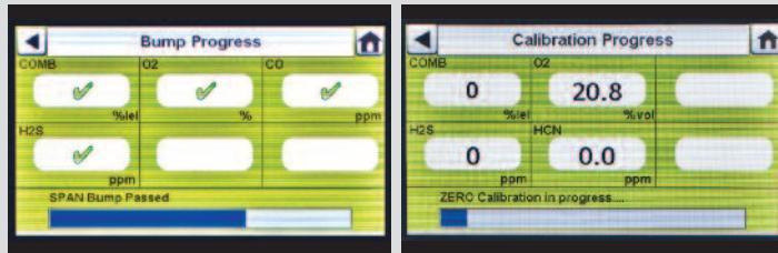
På skærmen Bump-status vises et timeglassymbol i hver sensorboks, indtil den pågældende sensors bump er fuldført. Grøn afkrydsning (✓) eller rød X (✗) vises for hver sensor, når bumpstenen er fuldført.
