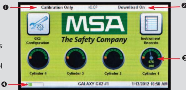
La pantalla Administrador proporciona las opciones de configuración para la estación de prueba, el instrumento y las botellas de gas de prueba:
