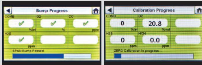
Sur l'écran de progression du test au gaz, un sablier est affiché dans chaque case de cellule jusqu'à ce que le test au gaz de la cellule soit terminé. Une coche verte (✓) ou une croix rouge (✗) est affichée pour chaque cellule lorsque le test au gaz est terminé.
