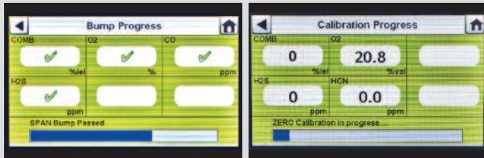
[バンプ実施中] 画面の場合、センサーのバンプが完了するまで、各センサーのボックスに砂時計記号が表示されます。バンプテストが完了すると、各センサーに対して緑色のチェックマーク (✓) または赤色の X (✗) が表示されます。
