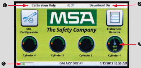
管理员屏幕提供测试台、仪器和测试气瓶的配置选项
