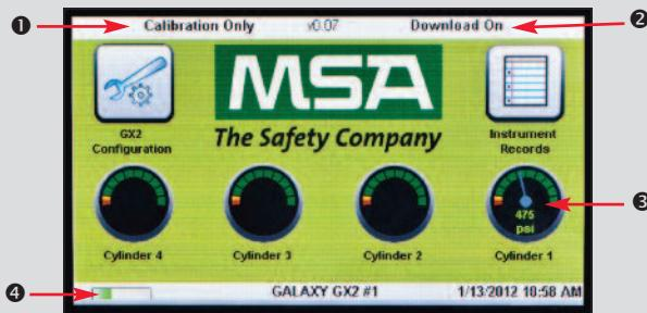
Järjestelmänvalvoja-sivulla konfiguroidaan testiasema, mittauslaitte ja testikaasupullot:
