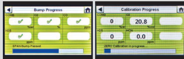
A Gyorsellenőrzés folyamat képernyőn egy homokóra jelzi az egyes szenzoregységet, amíg az adott szenzor gyorsellenőrzése befejeződik. Egy zöld pipa (✓) vagy piros X (✗) jelenik meg az egyes szenzoroknál, amikor a gyorsellenőrzés befejeződik.
