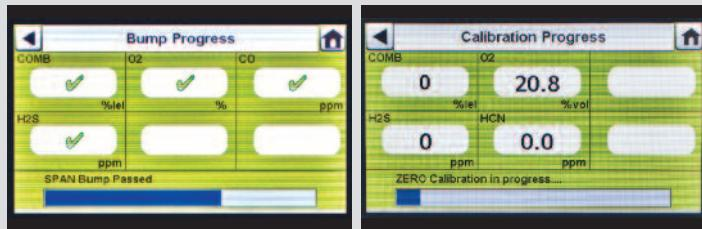
Na ekranie zaawansowania testu funkcjonalności Bump w oknie każdego czujnika będzie wyświetlana klepsydra aż do momentu zakończenia testowania tego czujnika. Po zakończeniu testu funkcjonalności bump dla każdego czujnika zostanie wyświetlony rezultat w postaci zielonego znacznika (✓) lub czerwonego X (✗).
