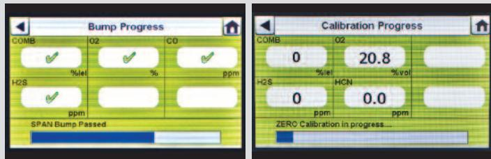
Per la schermata di avanzamento Bump test, sul display compare il simbolo della clessidra in ogni cassetta di sensore fino al completamento del bump test del sensore. Un contrassegno verde (✓) o rosso X (✗) comparirà sul display per ogni sensore quando è completo il Bump test.
