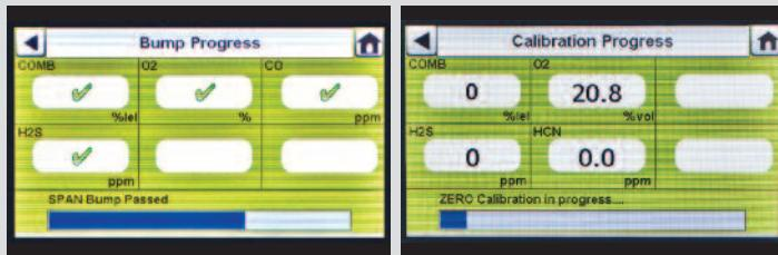
В екрані «Хід виконання перевірки з подачею газу» символ пісочного годинника залишатиметься у полі кожного датчика, доки не буде закінчено перевірку датчика. Після завершення перевірки з подачею газу для кожного датчика з'являтиметься зелена позначка (✓) або червоний хрестик (✗).
