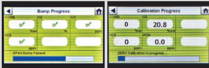
На экране «Ход проверки» в поле датчика будет отображаться значок с песочными часами, пока проверка датчика не завершится. После завершения проверки с подачей газа возле каждого датчика появится зеленая галочка (✓) или красный крестик (✗).
