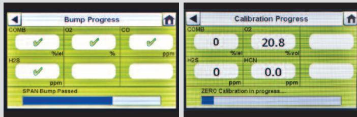
Na obrazovke priebehu zaťaženia sa zobrazí symbol presýpacích hodín v každom políčku senzora, kým nebude dokončené zaťaženie daného senzora. Po dokončení zaťaženia sa pre každý senzor zobrazí zelená fajka (✓) alebo červený znak X (✗).
