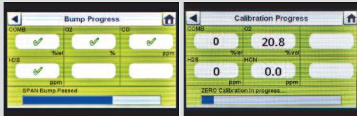
I skärmen Bumpförlöpp så visas timglassymboler i varje sensorruta tills bumpptestet för den sensorn är slutfört. En grön bock (✓) eller ett rött X (✗) visas för varje sensor när bumpptestet är slutfört.
