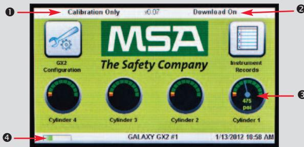
A tela Administrador mostra opções de configuração para a unidade de teste, o instrumento e os cilindros de gás de teste:
