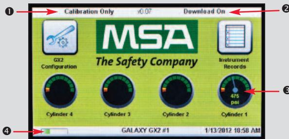
Ekran administratora zawiera opcje konfiguracyjne dla stacji testującej, przyrządu oraz butli z gazem.
