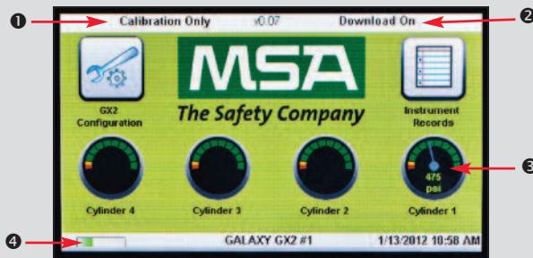
L'écran Administrateur propose des options de configuration pour le banc d'essai, l'instrument et les bouteilles de gaz de test :
