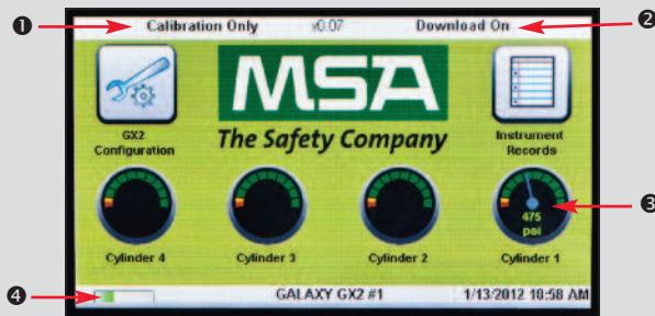
Der Bildschirm „Administrator“ umfasst die Konfigurationsoptionen für Prüfstation, Gerät und Prüfgasflaschen:
