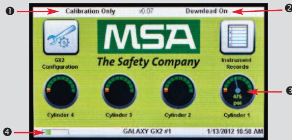
Ecranul Administrator furnizează opțiunile de configurare pentru standul de test, instrument și cilindrii de gaz de testare:
